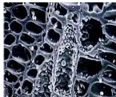
木炭の微細孔性状と微生物付着状況
